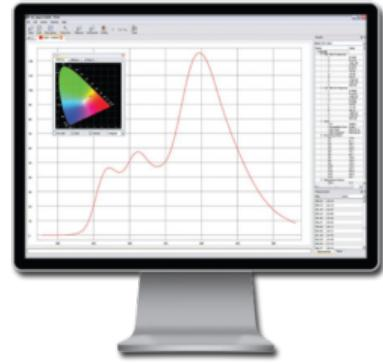
Le logiciel donne la possibilité à un utilisateur d'expérimenter avec les données collectées : de les tester (ex. PAS/FAIL), de les analyser selon les normes internationales (CIE, ISO etc.), de les comparer avec d'autres données (fenêtre de référence) et de faire des calculs. en utilisant différents paramètres (par exemple compter les valeurs d'intensité lumineuse).
